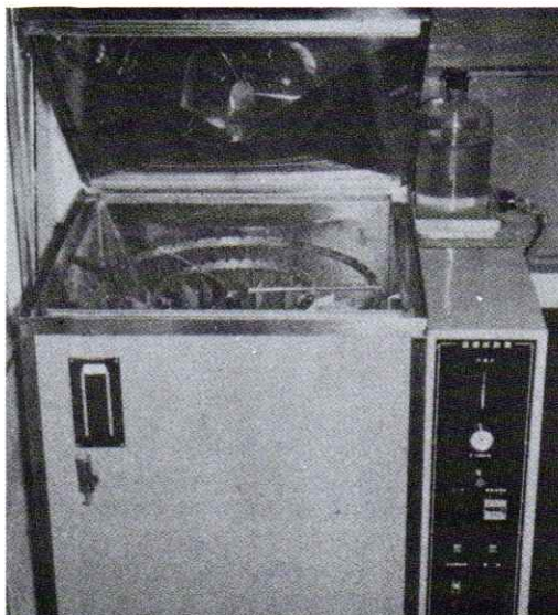
濕潤試驗器(Moisture Test)
